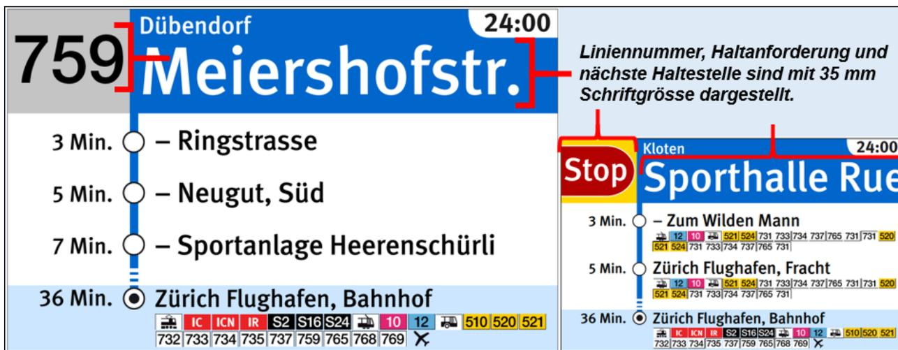
Abbildung 215: Beispiel Layout Multifunktionsanzeige (Beispiel rechts mit Laufschrift)
