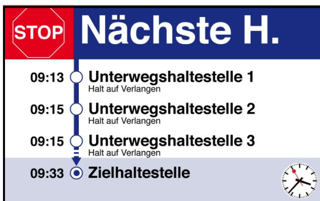
Abbildung 49: Bestätigung Halteanforderung als Wechselanzeige mit Liniennummer
